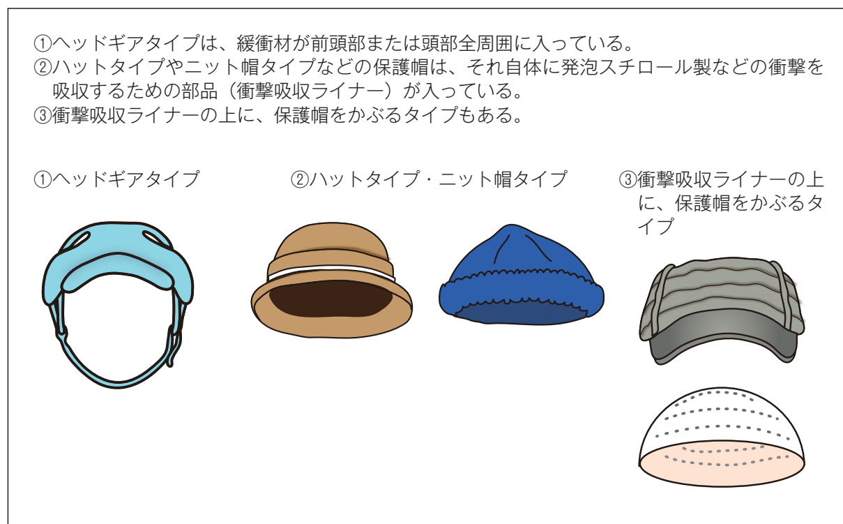
図4 保護帽のタイプと構造
